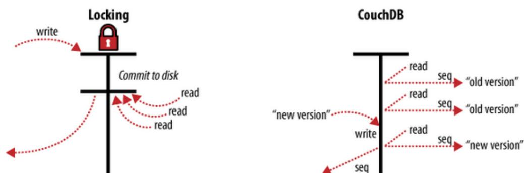
圖六 傳統資料庫與 CouchDB 在讀寫方面的比較圖
