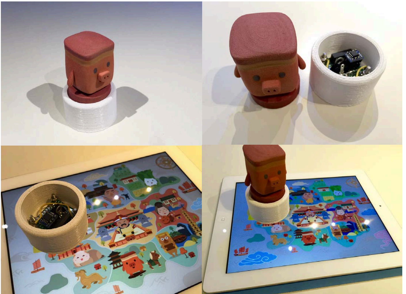
圖 11 3D 彩色列印公仔 觸控驅動雛型測試成功，未來可壓縮底座晶片裝置
