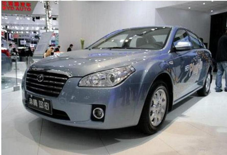
「一汽轎車」以奔騰轎車為基礎研發混合動力車型，係大陸自主品牌長安、奇瑞之後第 3 家具備自主研發混合動力汽車之廠家。奔騰混合動力版轎車的成本是汽油版奔騰車型的 2~3 倍，在進行量產後成本將逐漸降低。<sup>16</sup>奔騰混合動力轎車的動力系統由一具 1.5L 引擎和一個 288V 的鎳氫電池組成。該車最高時速達 191km/hr，從 0~100 公里的加速時間為 12.5 秒，燃料經濟性較傳統汽車減少 35%，該車排放廢
