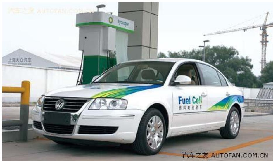
上海大眾帕薩特領馭燃料電池轎車動力系統總成，主要由燃料電池引擎、驅動電動馬達及控制器、單向 DC/DC 變換器 (使電流方向單向流動，穩定電壓)、鋰離子動力蓄電池組等組成。該車係以帕薩特領馭車型，透過新一代燃料電池轎車動力系統技術平台研製而成，該車以氫氣為能源，經氫氧化學反應生成水，實現零排放，<sup>29</sup>最高車速達 150km/hr，0~100 公里加速時間僅 15 秒，最大爬坡能力 20%，一次加注可行駛里程達 300 公里，在城市道路行駛輕汽燃料消耗率為 1.2kg/100km。
