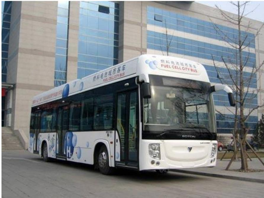
北京汽車集團有限公司自行研發的福田氫燃料電池客車，採用新一代燃料電池技術，<sup>30</sup>其排放物為純水，該車最高時速達 80km/hr，並可持續行駛 240 公里以上。
