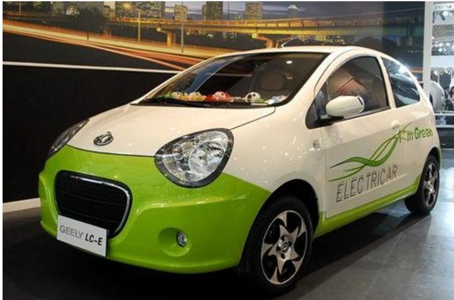
吉利熊貓純電動汽車，電源採用 40Ah 鋰離子電池，系統電壓 340V，完全充電需 5 小時，快速充電約 1 小時，<sup>25</sup>採用雙轉子直流差速電動馬達，最高車速 65km/hr，可連續行駛 80 公里。
