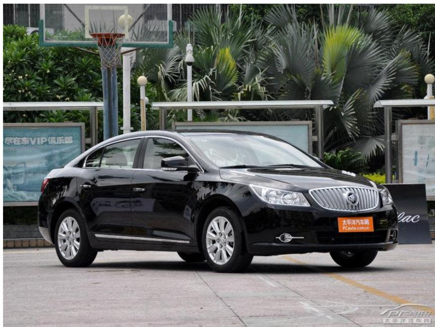
別克 LACROSSE 君越 Eco-Hybrid 油電混合動力車是大陸第一款中高階量產混合動力車型。該車採用獨立的電動馬達及鎳氫電池組的動力輔助系統，配合節能 2.4L ECO 智能引擎驅動該車，在車輛減速和靜止狀態下引擎自動停止燃油供應，實現零排放。<sup>19</sup>由於裝備電動輔助車速感應轉向系統，引擎斷油或停止行進對轉向不會產生任何影響。在起步和加速等動能需求大情況下，電動馬達自動啟動並提供動力輔助，減少燃料消耗，而當慢速行駛時則自動對電池組進行充電。君越 Eco-Hybrid 油電混合動力車綜合油耗下降達 15% 以上，由原先 9.8L/100km 降至 8.3L/100km，並大幅減少廢氣排放。
