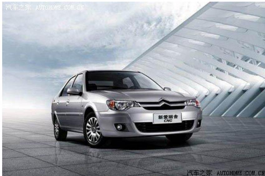
東風雪鐵龍推出新愛麗舍雙燃料汽車（圖片來源：汽車之家，<http://www.autohome.com.cn/news/200809/45790.html>，查詢日期 2012 年 7 月 10 日。），該車是在新愛麗舍標準型轎車的基礎上，採用汽油及壓縮天然氣電控多點噴射燃料供給系統的 1.6L 小型高能的兩用燃料引擎，<sup>36</sup>其汽油噴射系統選用與新愛麗舍相同的 BOSCH ME7.4 汽油電控系統，其中亦裝配適配義大利 LOVATO 最新一代的 CNG 壓縮天然氣多點噴射系統。
