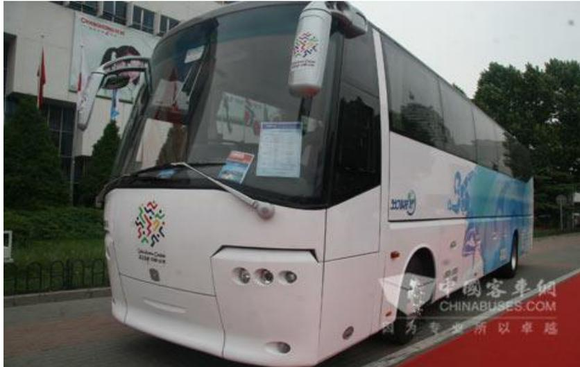
中通純電動客車採用純電動動力系統及電池管理系統，並具備網路通信系統，<sup>26</sup>可即時追蹤監測車輛動態行駛，配備 540Ah 大功率鋰離子電池，連續行駛可達 250 公里。
