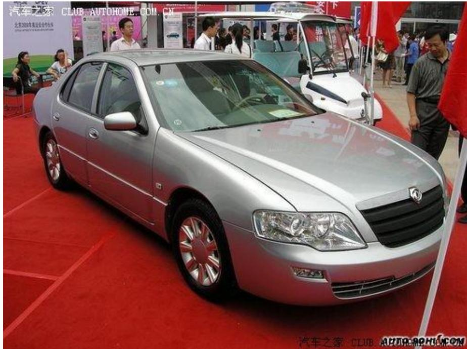
東風 EQ7200HEV 混合動力轎車是基於東風日產藍鳥平台的油電混合動力轎車。該產品主要技術特點在於採用混聯式的機電耦合方式、AMT 自動變速箱、節能電控系統、小排氣量汽油引擎、高效永磁同步驅動電動馬達，以及鎳氫電池及電控系統。該車動力系統係由東風雪鐵龍富康的 1.6L 引擎及鎳氫電池組成，車輛起步時由電動馬達驅動行進，當車速達到相當程度時，再由行車電腦與汽車引擎配合運作，目前該款車型仍以汽油動力為主，電池為輔。<sup>17</sup>最大車速大於 160km/hr；0~100 公里加速時間 14.5 秒；廢氣排放達到歐洲三期排放標準。
