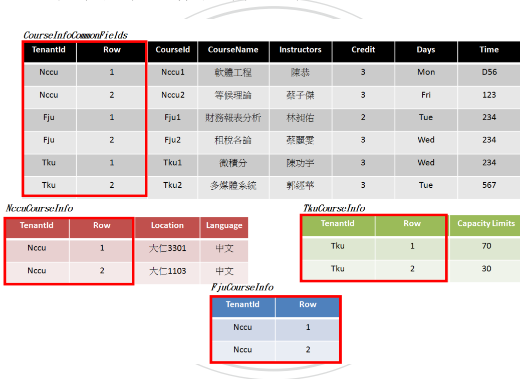
圖 2.8 基礎範例轉換成 Extension Table Layout 示意圖
