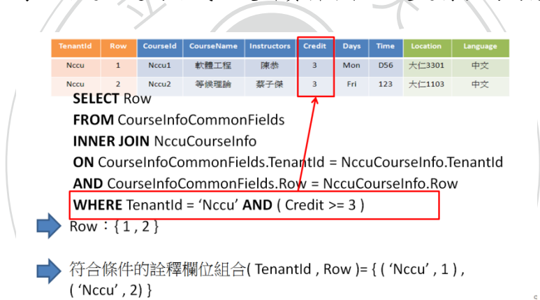
圖 3.26 UPDATE 語句轉換過程中，系統工具自動產生的 SELECT with JOIN 語句：找出符合 WHERE 條件式的資料集合，同時，記錄集合中每筆資料的詮釋欄位組合。
