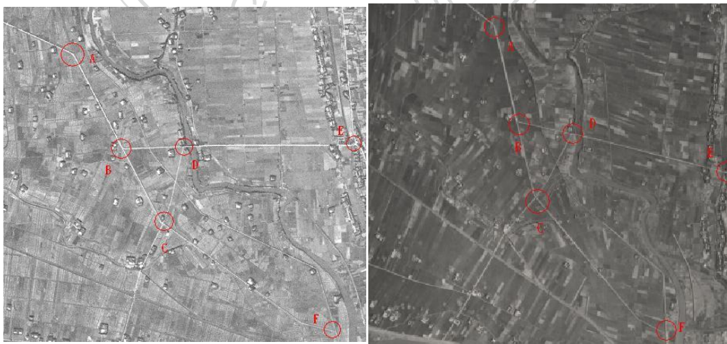
圖 3-6 左圖為 1971 年 Corona 衛星影像，右圖為 1947 年的舊航照影像。兩張影像比較可以發現在道路交點或轉折點幾乎一樣(圖上紅圈 A~F 點)。
