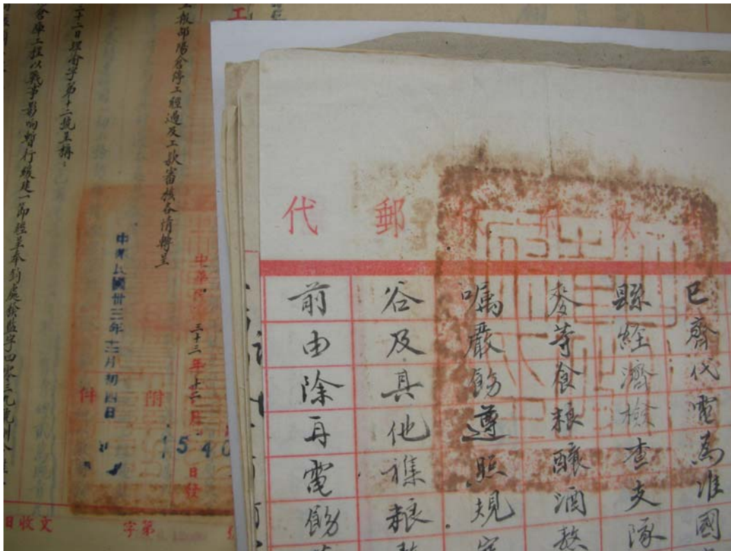
圖 4-7 紙張酸化情形：印章油墨氧化呈咖啡色
