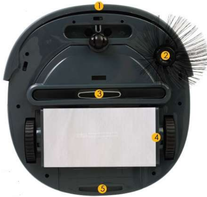
圖 2 『TAIHOYO PaPa Go V-BOT 智慧型吸塵器』底盤構造圖
